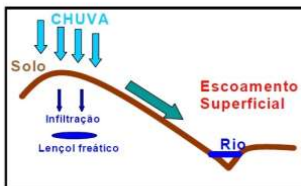
Figura 4 – Esquema do escoamento superficial em solo sem cobertura vegetal.
