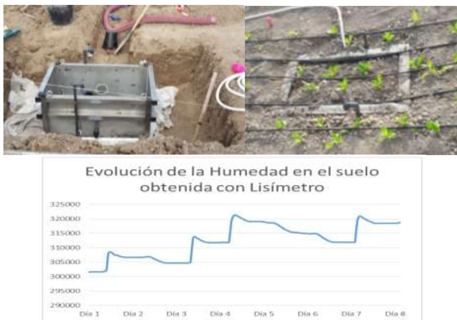
Figura 4. Lisímetro de pesada y algunos resultados obtenidos.
