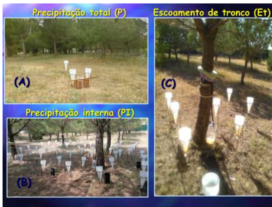
Figura 1. Pluviômetros de quantificação da precipitação total (P) precipitação interna (PI) e coletor de água do escoamento pelo tronco (Et) em Pinus halepensis – Albacete – Espanha.
