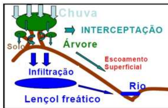
Figura 3 – Esquema do escoamento superficial em solo com cobertura vegetal. Segundo LIMA, 1999, a saúde da micro-bacia deve-se a perpetuação de seu funcionamento hidrológico, de seu potencial produtivo ao longo do tempo e da biodiversidade ao longo da paisagem.
