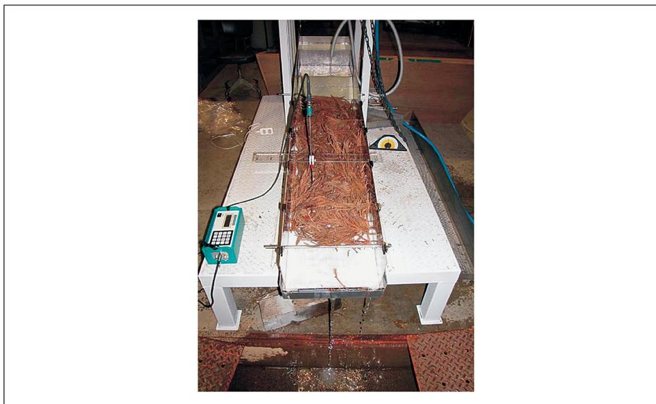
Figura 3. Ensaio laboratorial de curso de água empregando a serapilheira de *Cryptomeria*.
