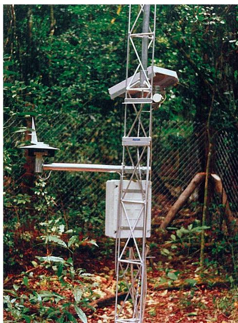
Figura 2. Estação meteorológica automática em fragmento de mata ciliar, Paraguaçu Paulista, SP.
